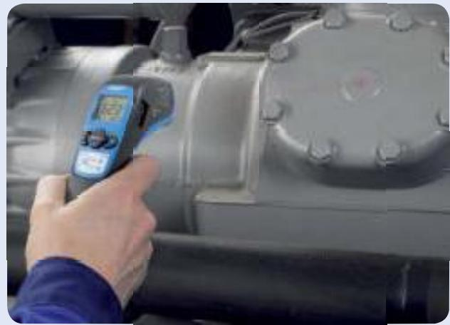
При использовании бесконтактного режима измерений термометр воспринимает тепловую энергию, излучаемую объектом, с помощью инфракрасного детектора. При наведении на объект инфракрасный датчик собирает энергию, производя сигнал, который микропроцессор транслирует как значение на экране.
