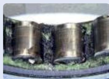
Деградация смазки, вызванная токами электрического разряда
