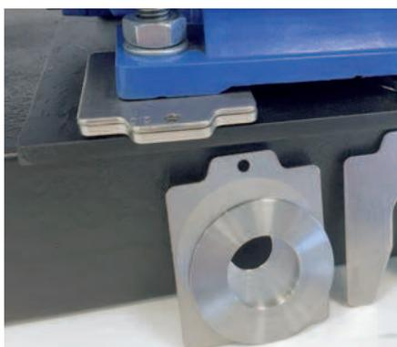
Пластины для коррекции угловой расцентровки
