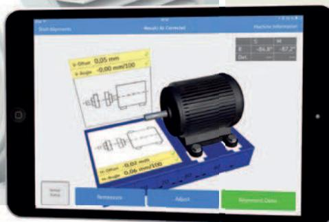
Широкие измерительные возможности и хорошие рабочие характеристики прибора для выверки соосности валов TKSA 51 отвечают требованиям как начального, так и экспертного уровня. Удобный в эксплуатации и не требующий специального обучения прибор для выверки соосности валов работает на базе приложения SKF для планшетов и смартфонов.
