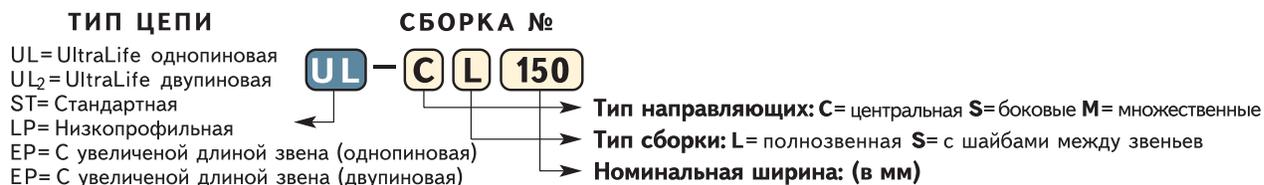
На этом примере номер UL-CL150, описывает конвейерную цепь с увеличенным сроком службы с однопиновым соединением, центральной направляющей, полнозвенную, 150 мм номинальная ширина. При заказе необходимо указать соответствующий тип цепи и номер сборки.
