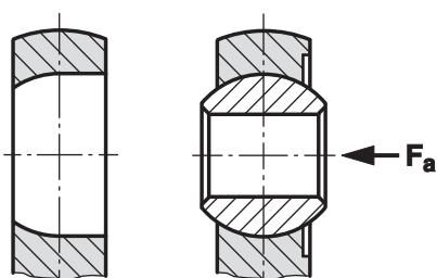
Отверстие в стальном корпусе имеет цилиндрическую форму с одной стороны и от середины корпуса шарнирной головки далее имеет такую кривизну, которая соответствует по форме внутреннему кольцу, имеющему форму шара (смотри рисунок).
