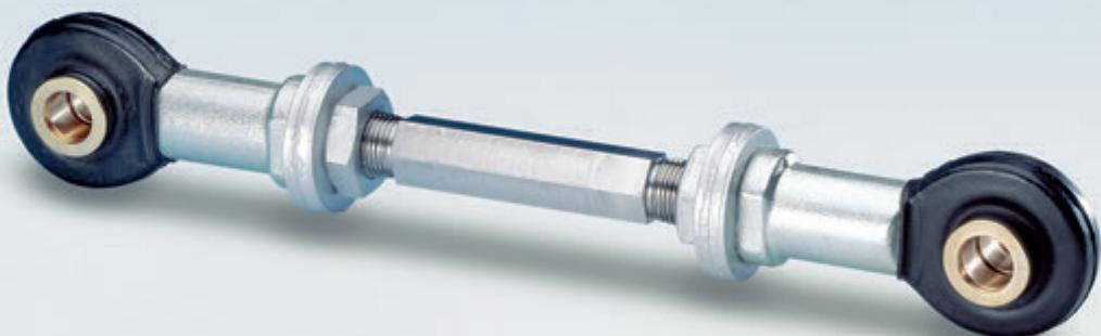
Соединительные шарниры для больших сил сжатия и растяжения, используемые в автомобилях. Шарнирные головки поставляются полностью готовыми с необходимым расстоянием между осями внутренних колец подшипника и углами поворота.
