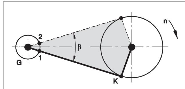
Рисунок 5: Угол осцилляции  $\beta$ , соответствующий повороту рычага
